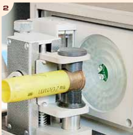
1 Позиционирование пули для сканирования боковой поверхности 2 Позиционирование гильзы для сканирования доньшка
