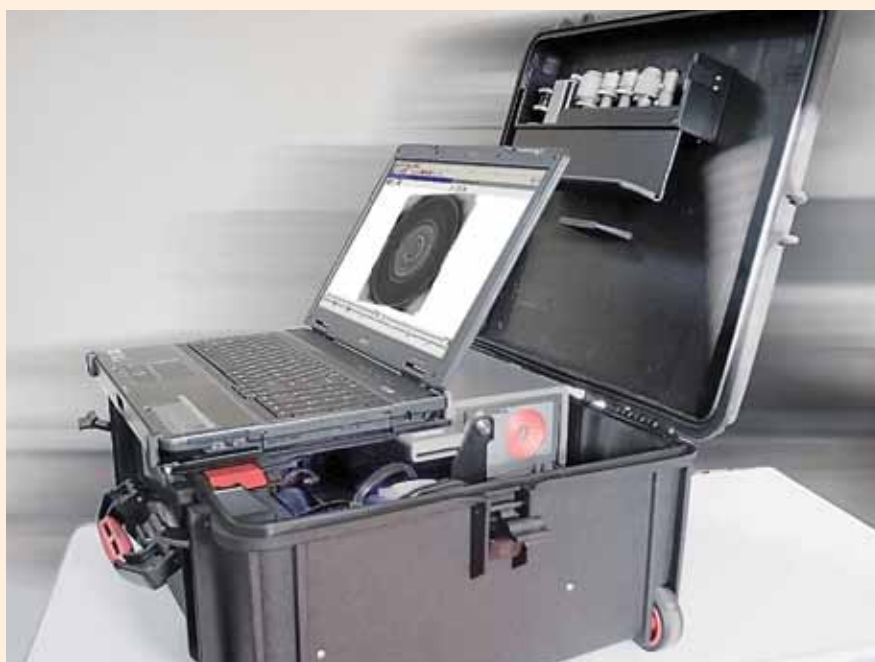
▮ Мобильный комплекс АБИС Арсенал в ударопрочном кейс-контейнере. Комплекс адаптирован к работе в автомобиле — электропитание осуществляется от автомобильной бортовой сети
