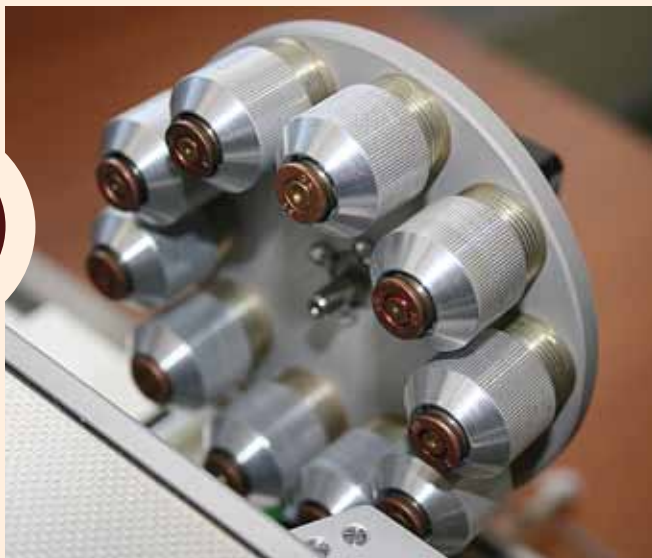
▶ Полуавтоматическое револьверное устройство для непрерывного сканирования доньшек партии гильз
