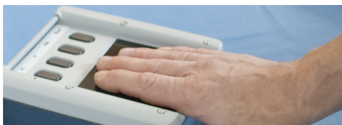
Сканирование контрольных оттисков четырех пальцев на сканере Папилон ДС-30Н
